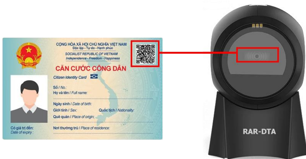
Hình 1. Đưa phần QR code trên thẻ CCCD vào vùng quét của thiết bị
